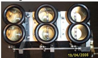
◀ Die Querschnitte der Anlagen sind **für Leistungen bis über 200kW ausreichend**, leistungsbestimmend sind und bleiben die durchgeführten Tuningmaßnahmen am Motor. Die maximale Kraftstoff-Fördermenge einer Kugelfischer-Pumpe vom Capri RS mit den serienmäßigen 6,5mm Kolben reicht bis ca. 150kW aus, oberhalb dieser Grenze sind meist tiefgreifende Änderungen an der Pumpe notwendig (z.B. Montage von Pumpenoberteilen mit größeren Kolben. Alternativ Umbau auf Elektronik, siehe unten)
