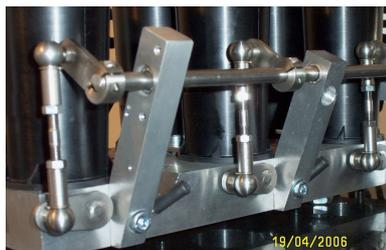
Die stark **progressive Anlenkung** und der **neue flachere Anstellwinkel** der Drosselklappen im unteren Lastbereich **verhindert das Abmagern** des Gemisches im Teillastbereich, die Verwendung einer Zentralwelle sorgt für **eine einwandfreie, temperaturunabhängige Synchronisation** bei warmen und kaltem Motor, da die Wärmeausdehnung der Grundplatte keinen Einfluß auf die Klappenstellung hat.
