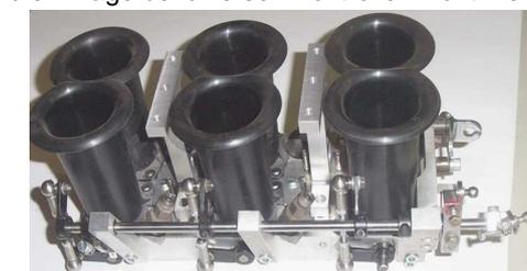
◀ Am Bild links sind die beiden zusätzlich montierten Halter Sammler-Zubehörsatzes zu erkennen (hier noch Version V2 abgebildet)
