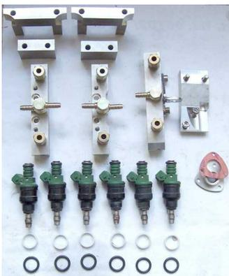
◀Umbauteile für Nachrüstung frei programmierbarer, Kennfeldgesteuerter Einspritzanlage (hier Teile für V2-Anlage, Zündungsteile ohne Abbildung)
