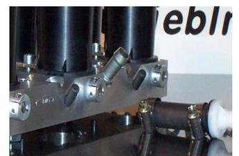
Ansaugtrichter aus Kunststoff tragen infolge der Wärmeisolierung zur **Senkung der Ansauglufttemperatur** bei und sind aufgrund des geringen Gewichts unempfindlich gegen Schwingungen. Die **neuartige Befestigung über lasergeschnittene Edelstahl-Halteplatten** ermöglicht die sichere Befestigung eines kpl. Trichterpaares mit lediglich 2 zentral angeordneten, gut zugänglichen Schrauben.
