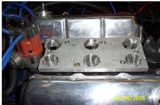
◀ Der Zwischenflansch kann mühelos auf einen stoßfreien Übergang zur Ansaugbrücke ohne deren Demontage und auch an ggf. bereits erweiterte Kanäle angepasst werden.
