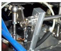
◀ Weiterhin wird zur Optimierung der Zündkennlinie der Nachrüstsatz „Teillaststeuerung“ angeboten. Über einen Mikroschalter an der Zentralwelle steuert ein Magnetventil die unterdruckgesteuerte Teillastdose des Verteilers an, wodurch das **Ansprechverhalten im Teillastbereich und vor allem der Benzinverbrauch des Motors erheblich verbessert wird**. Alle Anlagen sind selbstverständlich bereits dafür vorbereitet.
